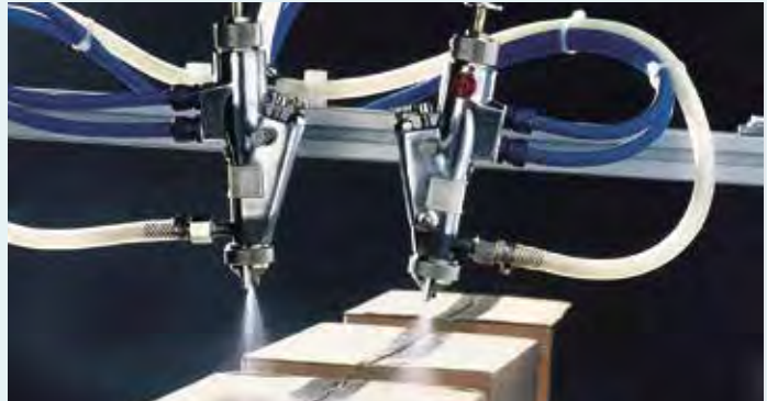
Spritzpistolen im Einsatz in der Verpackungsindustrie z. B. Sicherung von Palettenladungen mit Haftschmelz-Klebstoff. Spray guns being used in the packaging industry.
